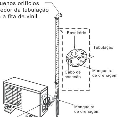
Um loop evita que a água penetre nas partes elétricas.
