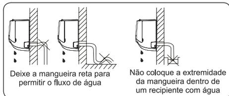
2. Se for preciso instalar uma extensão na mangueira de drenagem, isole a parte da conexão com um tubo de proteção. Não deixe que a mangueira de drenagem fique frouxa.
