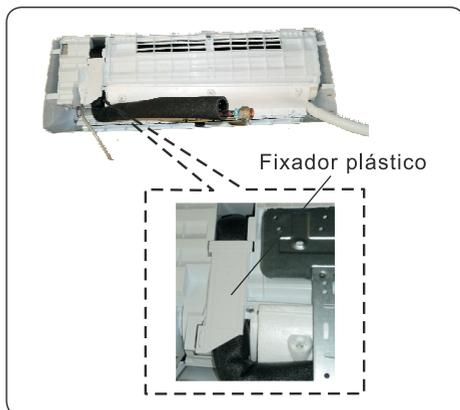
**Atenção:** Durante a instalação da unidade interna, certifique-se de remover as partes necessárias (veja figura ao lado). Isto permitirá a instalação da tubulação e do cabo elétrico sem que a unidade seja danificada.
