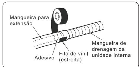
**B.** Passe o material de isolamento térmica ao redor das conexões da tubulação:
