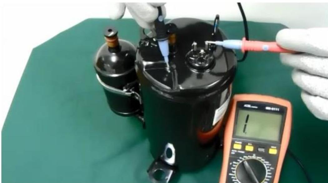
Se o compressor estiver em bom estado, não deve apresentar continuidade em nenhum dos três toques se em um dos toques houver indicação de valor no display, o compressor está com fuga de continuidade entre os enrolamentos e tubulação do sistema. O que provocará a fuga de corrente. Neste caso substitua o compressor.
